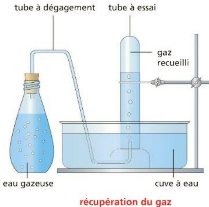
Du gaz s'échappe de la bouteille de Perrier, passe par le tube à dégagement puis monte dans le tube à essai en prenant la place de l'eau.
